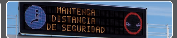
PANEL DE 2 ZONAS GRÁFICAS DE 64 x 64 PÍXELES DE 3 LEDS/PÍXEL (RGB) Y 3 LÍNEAS DE 12 CARACTERES DE 11 x 16 PÍXELES DE 1 LED/PÍXEL, ALTURA DE LETRA 400 mm
